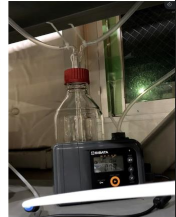
버퍼 탱크 및 펌프
