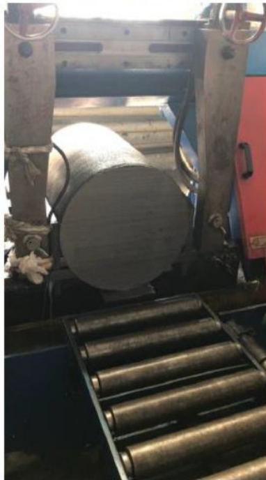
Nb ingot ( \Phi 480\text{mm} )
