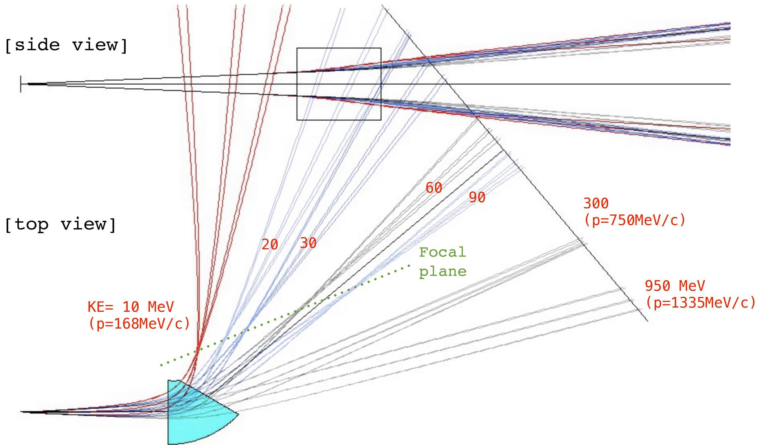
2)  $R=1.0\text{m}$ ,  $B_{DP} = 1.0\text{T}$ ,  $\beta=20^\circ$ ,  $\theta=60^\circ$
